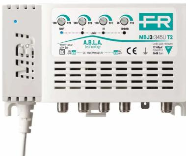
Amplificateur pour intérieur autoalimenté à 3 entrées (III+DAB, UHF) avec un gain de 20dB et un niveau de sortie jusqu'à 115dB $\mu$ V dans la bande UHF, amplification séparée des bandes, réglage du niveau indépendant (20dB) pour chaque entrée et faible facteur de bruit. Technologie T2 avec filtre intégré pour éliminer les interférences 5G à 694MHz.
